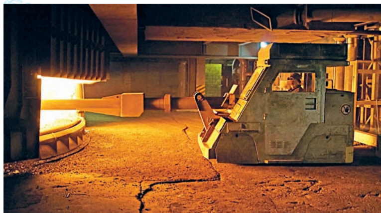
Плавильщик Виктор Титов работает на шуровочной машине «Dango & Dienenthal»
