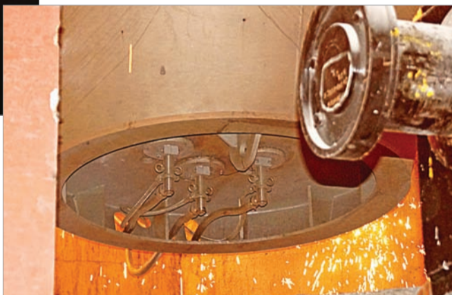
По этим трубкам и фурмам снизу в конвертер подается газ с газосмесительной станции
